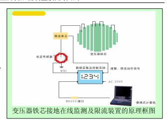
模块实现实时监控。下位机可向上位机实时发送电流、时间、电阻的投切状态、下位机的 工作模式等多种监测数据,也可上传保存在下位机 FLASH 存储器中的历史数据,上位机获 得了下位机上传的数据后可以进行波形显示,历史数据的分析以及初步的故障诊断等。
